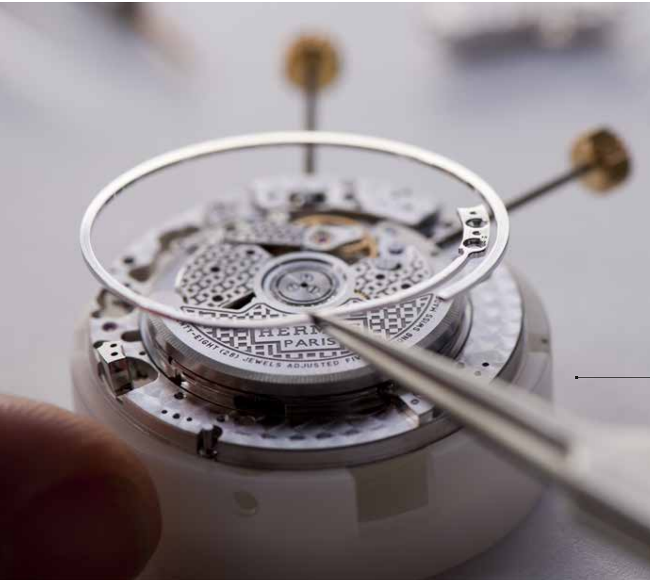
Plaatsing van de gong dankzij dewelke l'Heure Impatiente d'Hermès zal kunnen weerklinken.
